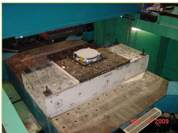
Рисунок 4 – Изолятор во время расположения в стенд в Лаборатории в г. Сан Диего, Калифорнии, США
