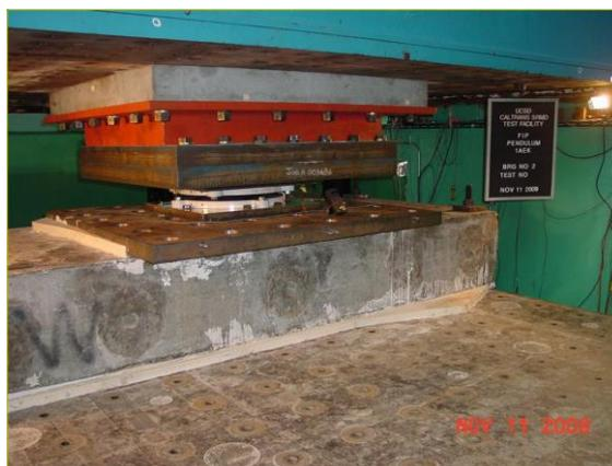
Рисунок 5 - Изолятор во время испытания в Лаборатории в г. Сан Диего, Калифорнии, США
