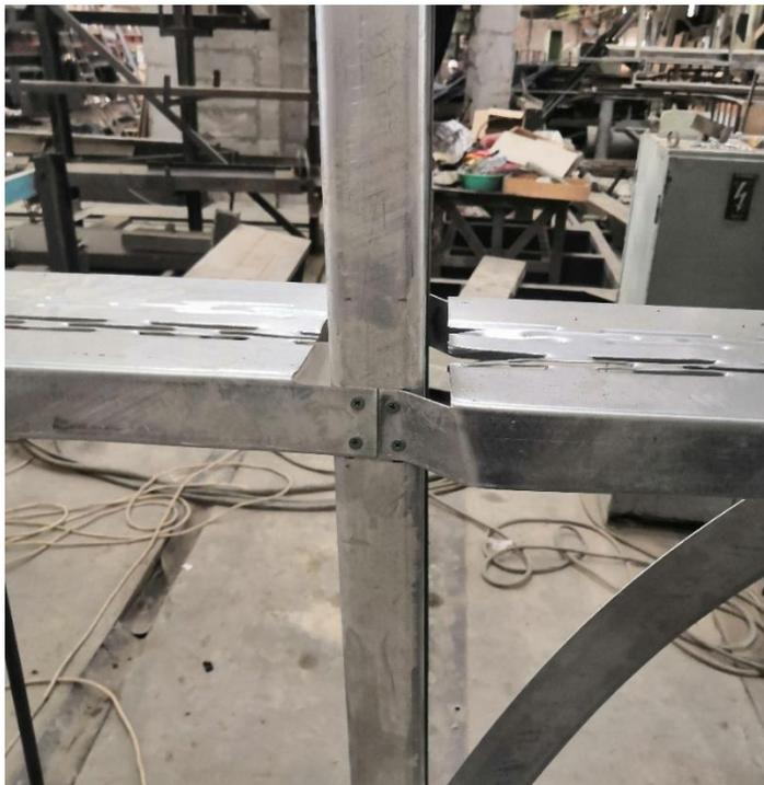
*Рис.15. Деформирование распорки в зоне соединения*
