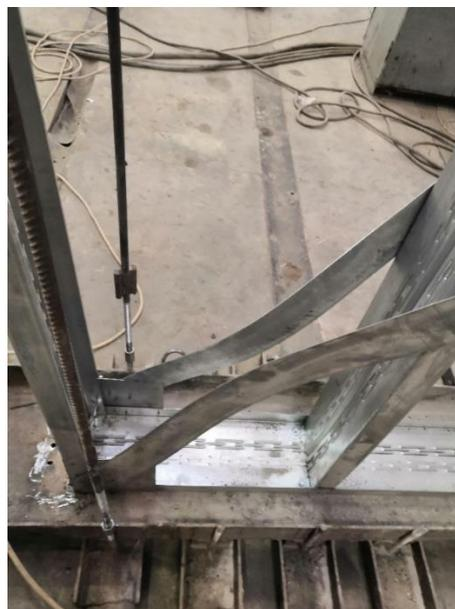
*Рис.13. Потеря устойчивости сжатой ветви вертикальной связи*
