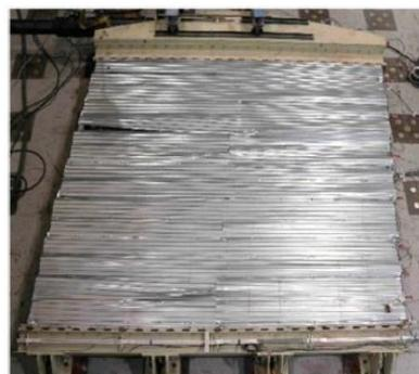
**Рис. 5.** а) Образец горизонтальной диафрагмы (перекрытия) с обшивкой из деревянных конструкционных панелей [24]; б) образец горизонтальной диафрагмы (перекрытия) со стальным настилом [25]
