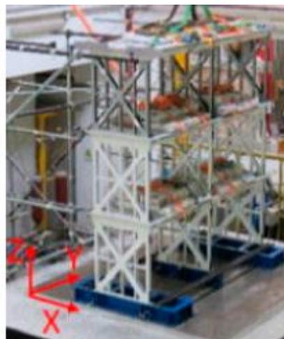
**Рис. 4.** Экспериментальные образцы моделей и фрагментов зданий, испытанных на сейсмоплатформах: а) здание из каркасных конструкций несущих стен с панелями обшивки из гипсокартонных листов [21]; б) модель здания из каркасных конструкций несущих стен с крестообразными связями [22]
