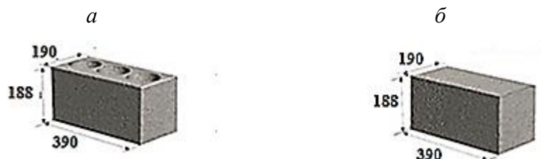
Рис. 2 Стеновые блоки из легких бетонов: а- с пустотами; б- сплошные
