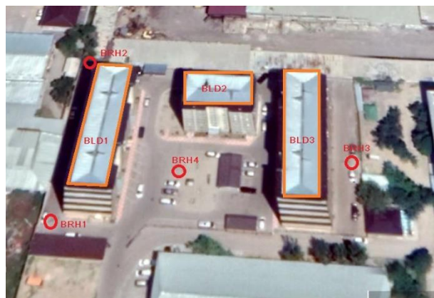
Рис. 4. Карта-схема расположения сети акселерометрических мониторинговых скважин (красные кружки) и построек (оранжевые прямоугольники).
