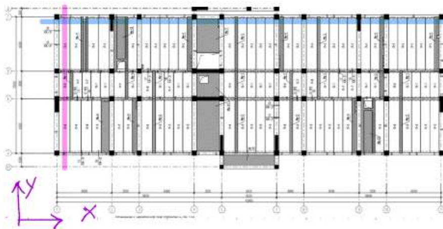
Рисунок 3. План типового этажа, показывающий сечения для расчетов по направлениям X (выделено синим) и Y (выделено розовым)
