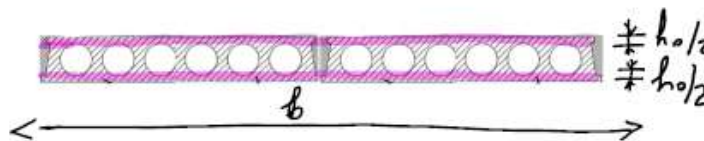
Рисунок 18. Критическое сечение для проверки прочности на сдвиг в направлении X
